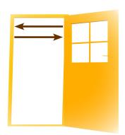
IF DOOR IS NOT ON THE RIGHT HEIGHT, ADJUST 3 SCREWS ON DOOR HINGES.
